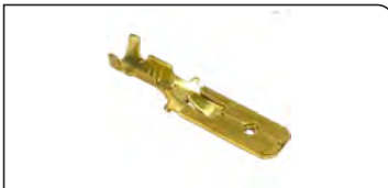
10984 TERMINAL LATAO ENCAIXE MACHO 6,3MM P/ FIO 1,00 ATE 2,50MM C/ TRAVA ESPADÃO
